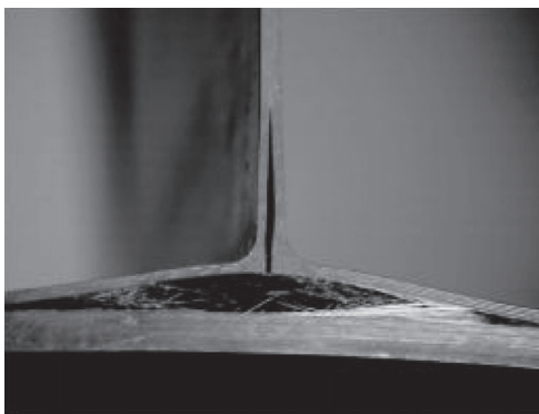
图 7 典型复合材料层合板 T 型接头拉脱破坏模式 [9,16] Fig.7 Pull-off test of T-joints by laminar [9,16]
